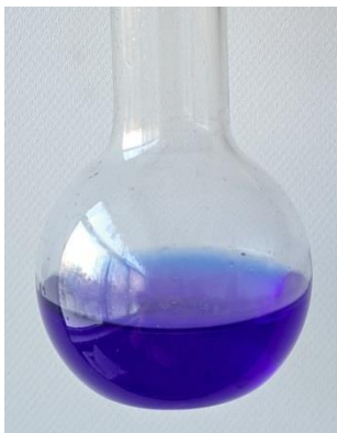
Рис 9. Образовавшийся ярко-синий раствор в результате реакции \text{Cu}(\text{OH})_2 и \text{NH}_3
