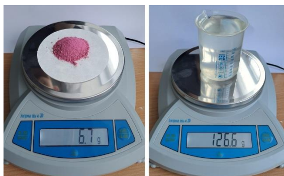
Рис. 5. Отмеренные количества сульфата кобальта и воды для приготовления раствора нужной концентрации
