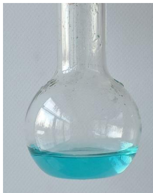
Рис 8. Образовавшийся голубой раствор в результате реакции \text{Cu}(\text{OH})_2 и \text{HCl}
