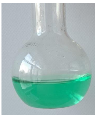
Рис 11. Образовавшийся зеленый раствор в результате реакции \text{Ni}(\text{OH})_2 и \text{H}_2\text{SO}_4
