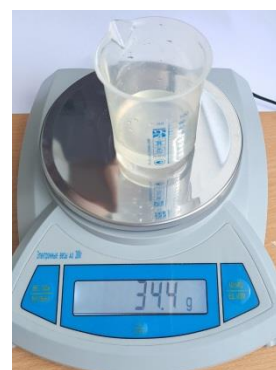
Рис 4. Отмеренное количество NaOH для проведения реакции с сульфатом никеля
