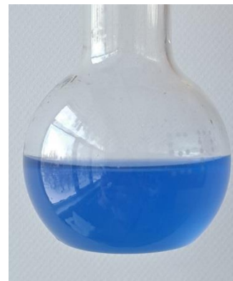
Рис 10. Образовавшийся синий раствор в результате реакции \text{NiSO}_4 и \text{NH}_3
