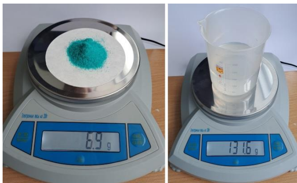
Рис. 1. Отмеренные количества хлорида меди (II) и воды для приготовления раствора нужной концентрации
