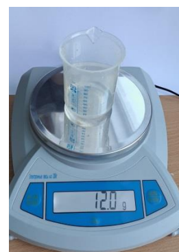
Рис 6. Отмеренное количество раствора NH 3 для проведения реакции с сульфатом кобальта
